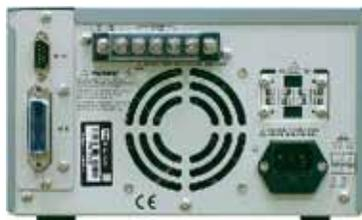
PSM - 系列是一款单路输出 / 双档位、120W / 200W 的可编程线性直流电源。OVP、OCP、OTP 和输出 On/Off 控制功能保护 PSM - 系列和负载免受意外损坏。高分辨率、低变动率和低涟波分别保持在 1mV/1mA、0.01% 和 <350μVrms。数字式界面和清晰的 LCD 显示简化了用户的操作和设置。标准特点包括:保存 / 调取输出;通过设置连续测试时间和自我测试时间,自动按步运行;以及软件校正功能。SCPI 编程、LABVIEW 驱动、RS-232C 和 GPIB 接口用于远程控制和 ATE 开发。PSM 系列是高精度领域,如 QA 认证和产品研发的理想选择。
