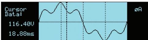
压、频率和波形。这进一步加强MX模拟交流线路情况或直流干扰的能力。当结合多相任意波形能力，交流和直流输出潜力就真正被扩展了。瞬态发生器可被独立地控制3个相位同步。准确的相位角控制和同步的瞬态列表执行使得交流电源具有无可比拟的精确性。
